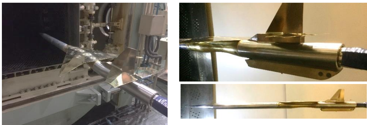
図 3 風試模型の遷音速風洞への設置状況
