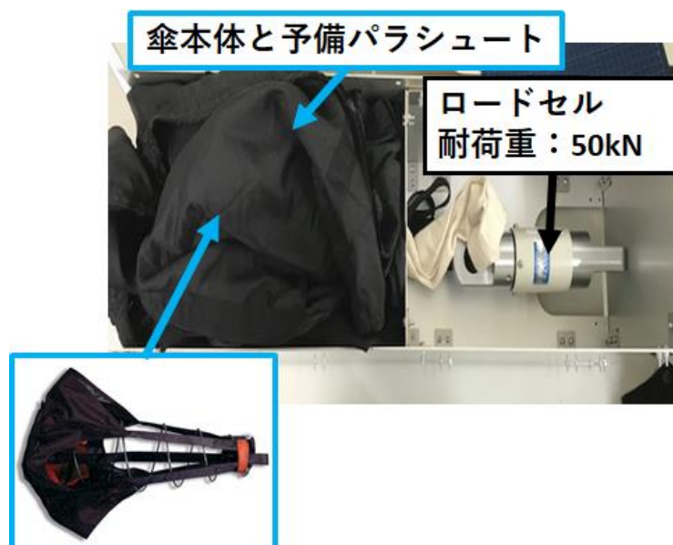
図2 1号車ボックス内のドラッグシュート収納状態
