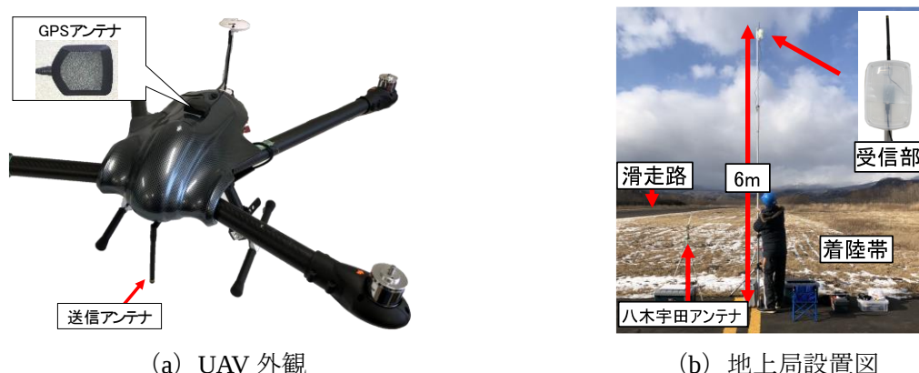
図 4 UAV および地上局への無線機設置状況
