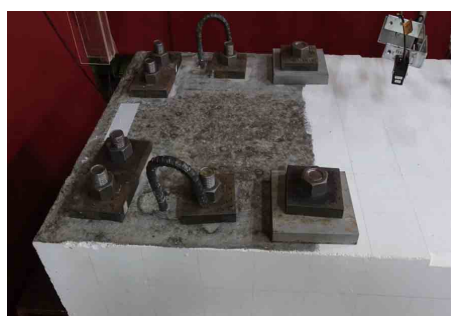
写真-2 固定部の定着状況
