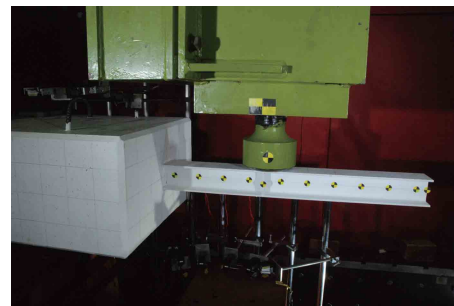
写真-4 衝撃荷重実験状況
