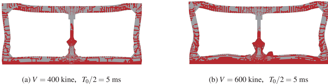
図-13 速度 V を変化させた場合の躯体の変形状態とコンクリートのひび割れ発生及び圧壊状況
