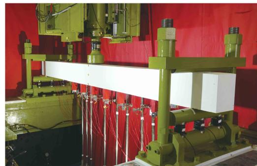
写真-2 衝撃载荷実験状況
