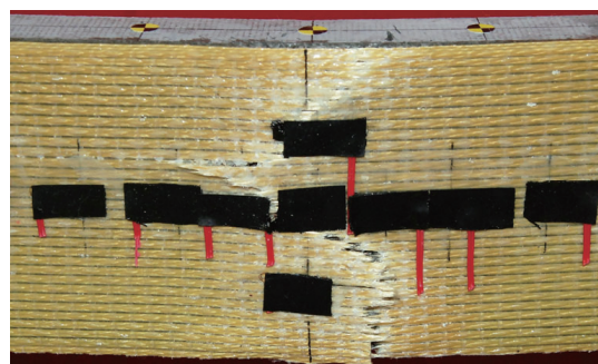
写真-5 PFC1-H600試験体のシート破断状況
