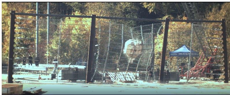
写真-4 重錘最大貫入時とその捕捉状況
