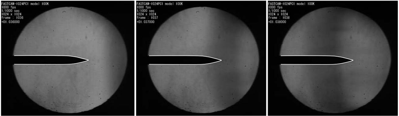
第 7 図 マッハ 3 の反射衝撃波の挙動 ( $t = 1.036 \sim 1.038$  秒)
