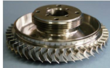
(d) A fabricated turbine blisc.
