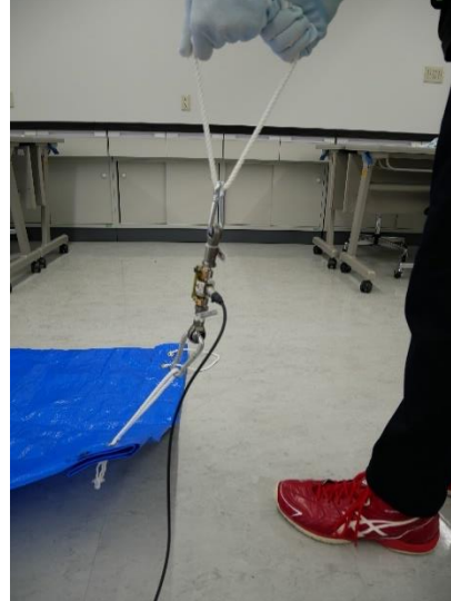
図 3.5-2 持ち手とロードセルの接続
