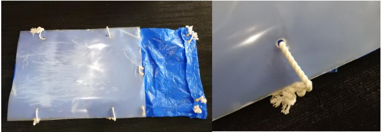
図 4.2-2 ブルーシート底面の PP 板と固定部
