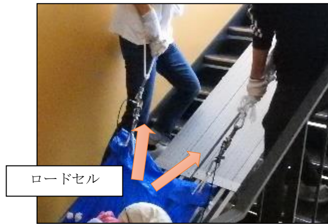
図 4.5-2 被験者の持ち手とロードセルの配置
