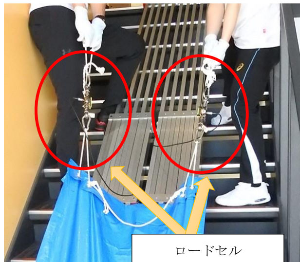
図 3.5-3 被験者とロードセルの配置
