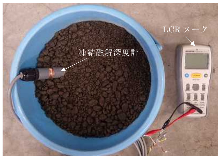
写真-5.3.1 凍結融解深度計の埋設状況
