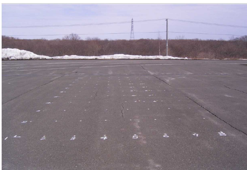
写真-4.1.1 苫小牧寒地試験道路における凍上量測定
