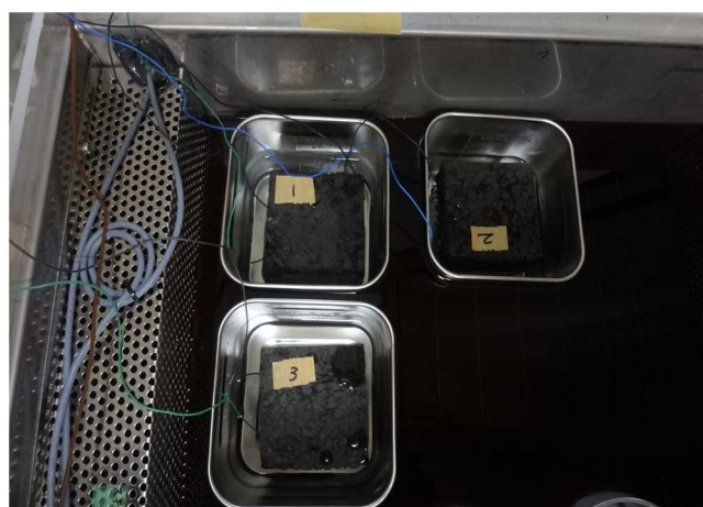
写真-8.3.6 凍結融解供試体の設置状況
