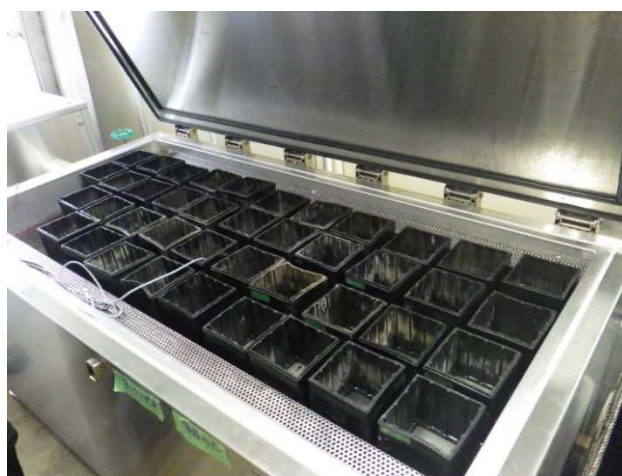
写真-8.3.5 凍結融解試験装置
