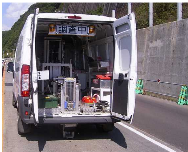
写真-3.3.2 調査に用いた FWD 試験装置
