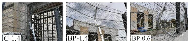
写真-6.3 衝撃荷重載荷部の柵の損傷状況
