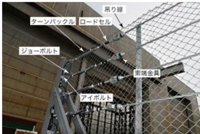
図-2.1 ワイヤロープ用ロードセル
