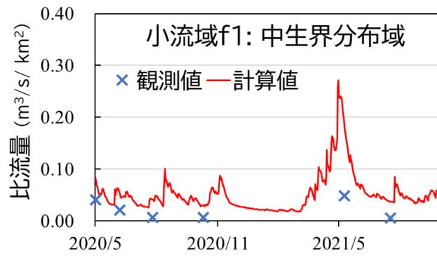
図 4-7 (2) 追加流域の小流域の現況流量再現結果 (続き)
