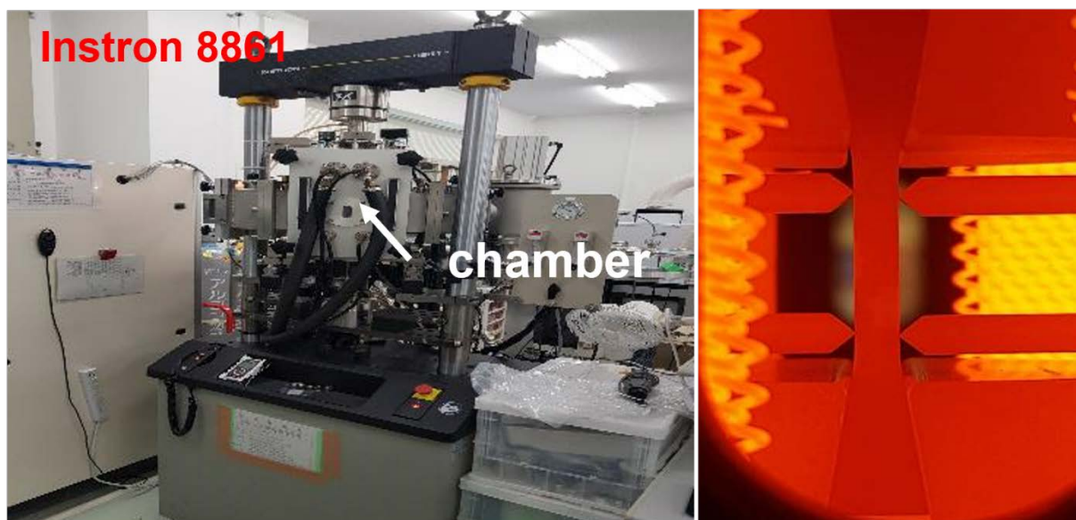
図 4-1-1 引張試験機の写真
