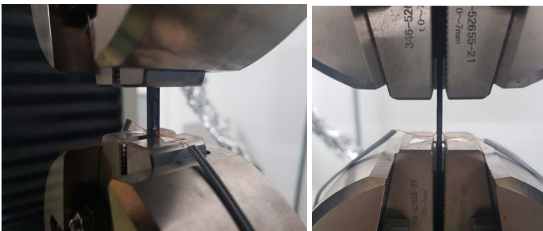
図 3-2-3 引張試験用治具の写真、引張試験片中の写真
