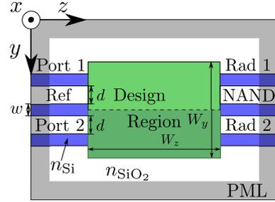
図9 光 NAND ゲートの最適設計のための問題設定
