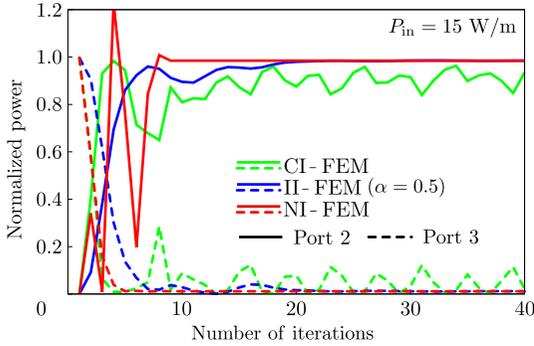
図4 反復回数に対する出力パワーの変化
