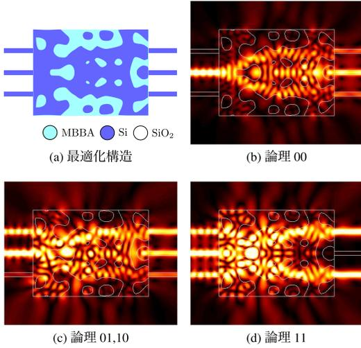
図 10 光 NAND ゲートの最適化結果
