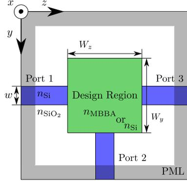
図6 光スイッチ最適設計のための問題設定
