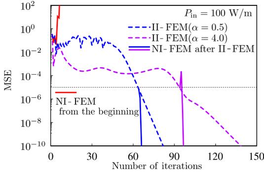
図8 光スイッチの解析における反復 FEM の収束性の比較
