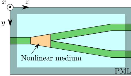
図1 Kerr型非線形媒質を含む2次元光導波路
