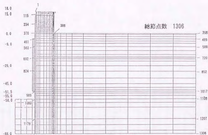
図-8.14 応答加速度、変位を検討するために着目した節点の位置
