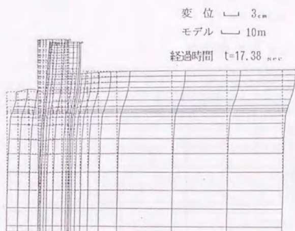
地中連続壁に最大応答加速度発生時 ( t=17.38 秒)
