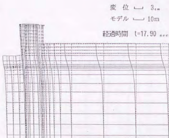
海底地盤周辺境界部に最大応答加速度発生時 ( t=17.90 秒)
