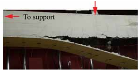
(b) Sheet debonding (Beam A-T0)
