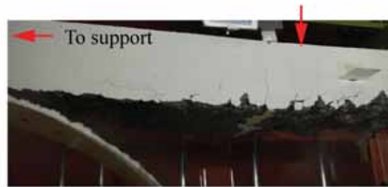
(b) Sheet debonding (Beam A-T0)
