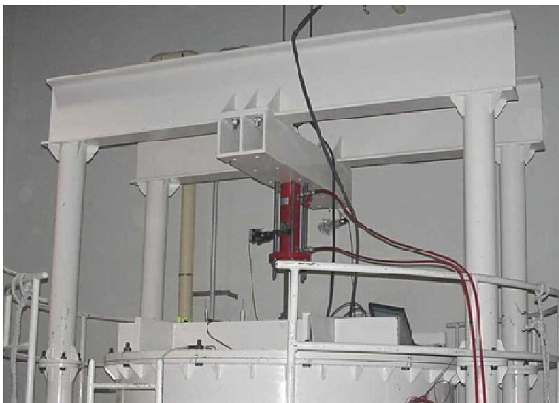
写真 2.3 載荷フレーム
