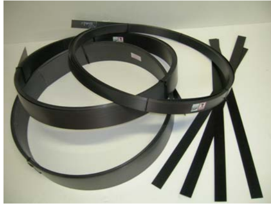
写真 4-2 CFRP プレート
