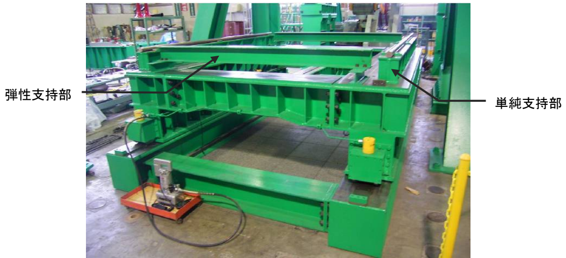
写真 2-3 供試体を設置する架台
