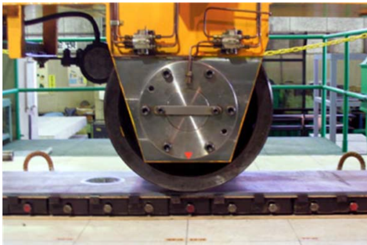
写真 2-4 鉄輪による載荷と鋼製ブロック
