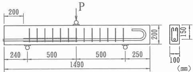
図-1 鉄筋コンクリートはり
