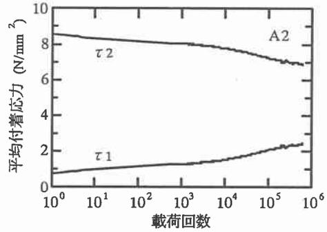
図-8 乾燥状態における荷重載荷回数と付着応力の関係
