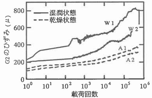
図-7 荷重載荷回数とひずみの関係
