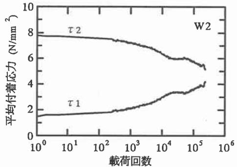
図-9 湿潤状態における荷重載荷回数と付着応力の関係
