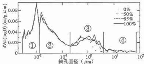
図-7 静的載荷による細孔径分布
