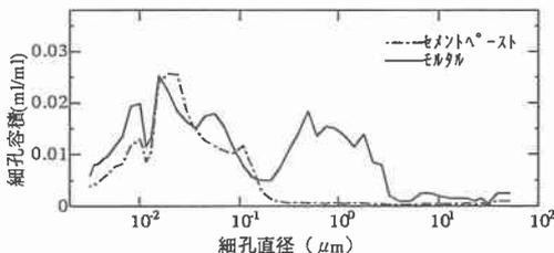
図-6 セメントペーストとモルタルの細孔径分布
