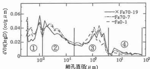
図-15 大気中疲労、上限応力比70%の細孔径分布(中心部)
