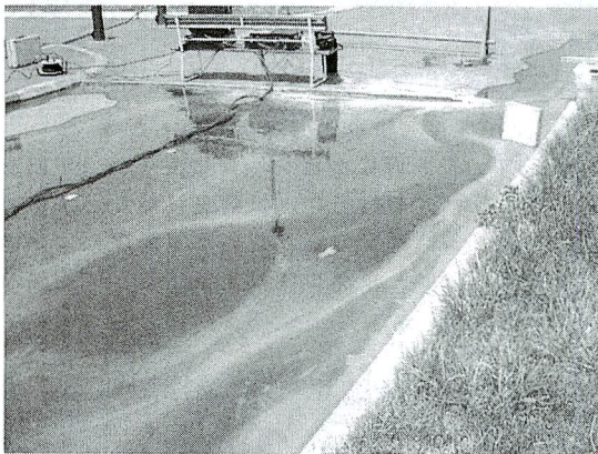
写真7 絵の具による流速計測状況
