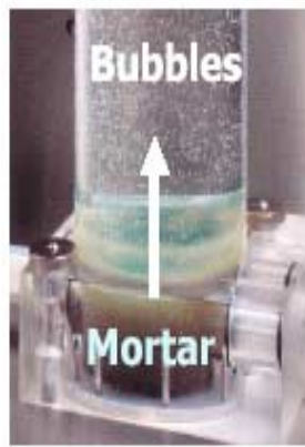
写真 - 2 気泡上昇時の状況
