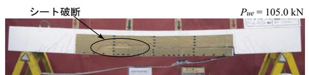
(c) S1-h3 試験体 (繊維強化方向 : 梁軸方向)
