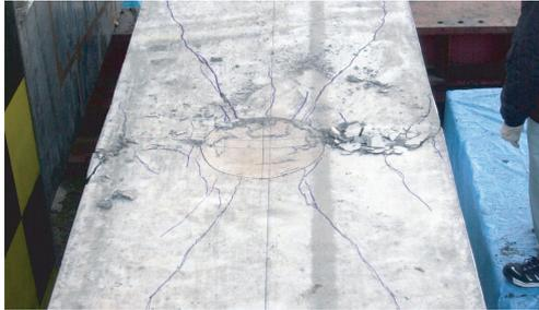
写真-1 重錘衝突部の RC 桁の損傷状況
