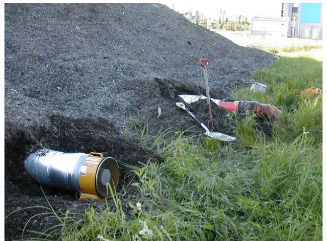
Fig.3.3 雪山端部の排気部 (手前) と吸気部 (奥)
