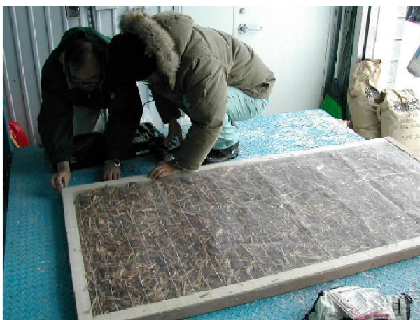
Fig.4.2 試験体 (バーク材+防虫ネット)
