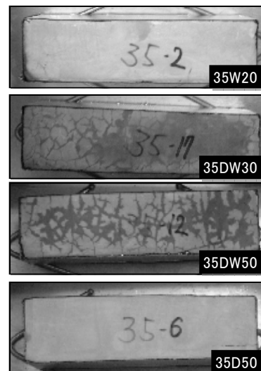
図-4 環境変化後（下面吸水開始直後）の供試体上面の様子
