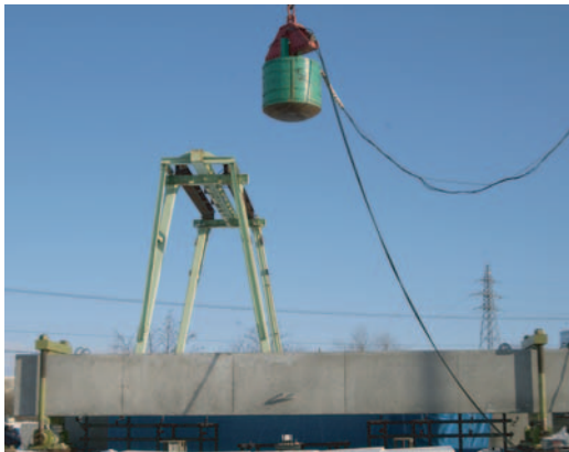
写真-1 重錘落下衝撃実験状況 ( W_m = 5\text{ t} , H = 4\text{ m} )
