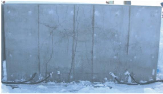
写真-2 RC擁壁 (PH250) の直接衝突実験後のひび割れ状況
