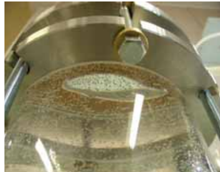
図-6 水道水のための透水試験
