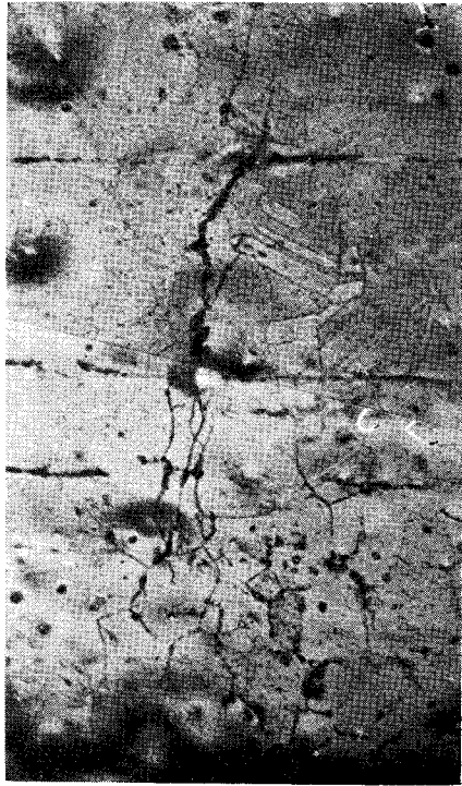
写真 29 焼鈍材の亀裂組織 × 300 初期応力 = 9.24kg/mm 2 破断時間 = 903min.
