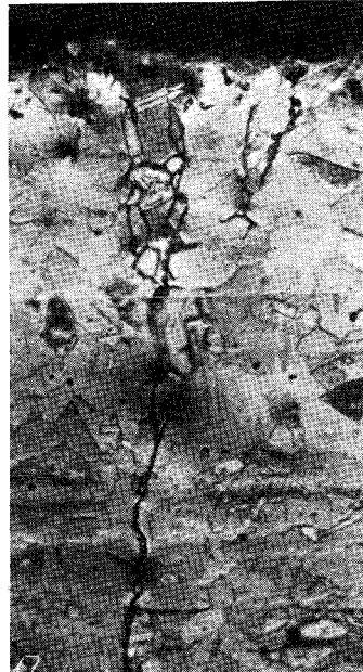
写真 27 焼鈍材の亀裂組織 \times 300 \times \frac{4}{5} 初期応力 = 12.15kg/mm 2 破断時間 = 797min.
