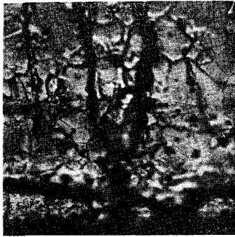
写真 24 焼鈍材の亀裂組織 \times 90 \times \frac{4}{5} 初期応力 = 13.32kg/mm 2 破断時間 = 406min.
