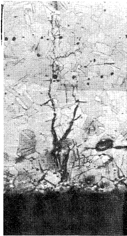
写真 22 焼鈍材の亀裂組織 初期応力 = 18.40kg/mm 2 破断時間 = 116min.
