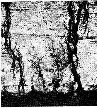
写真 24 焼鈍材の亀裂組織 \times 90 \times \frac{4}{5} 初期応力 = 13.32kg/mm 2 破断時間 = 406min.
