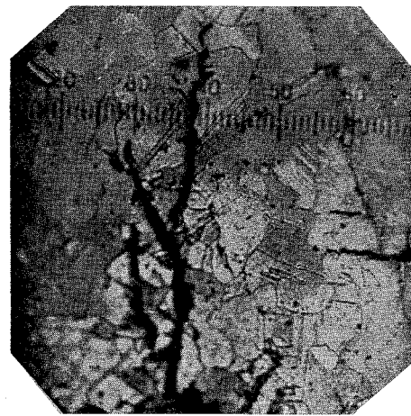
写真 13 焼 鈍 材 引張応力 = 8.93 kg/mm 2 破断時間 = 110 min
