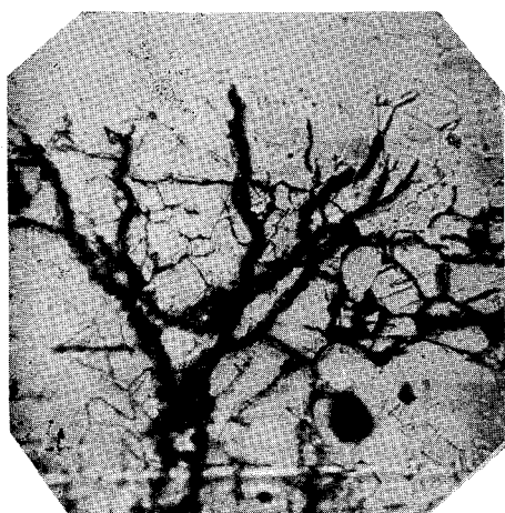
写真 12 焼 鈍 材 引張応力 = 17.12 kg/mm 2 破断時間 = 27 min 亀裂拡大を示す。
