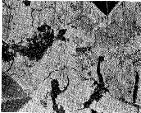
写真 21 Al 鑄鉄 800°C; 5 時間 ×425 腐食 (中央附近)
