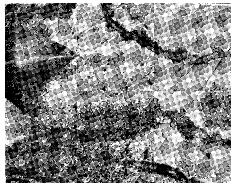
写真 20 Al 鑄鉄 700°C; 10時間 ×425 腐食 (中央附近)
