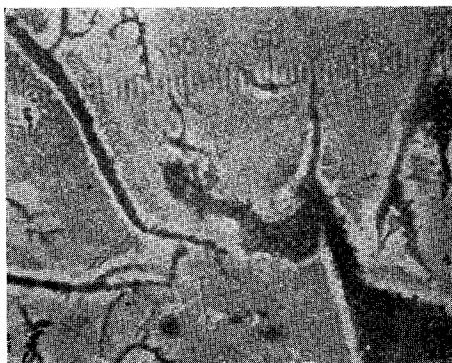
写真 10 Al 鑄鉄 (A-II) (焼鈍) ×300 5% Nital エツチ
