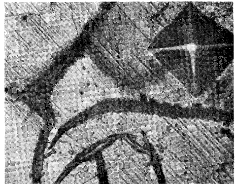
写真 22 Al 鑄鉄 800°C; 10 時間 ×425 腐食 (中央附近)
