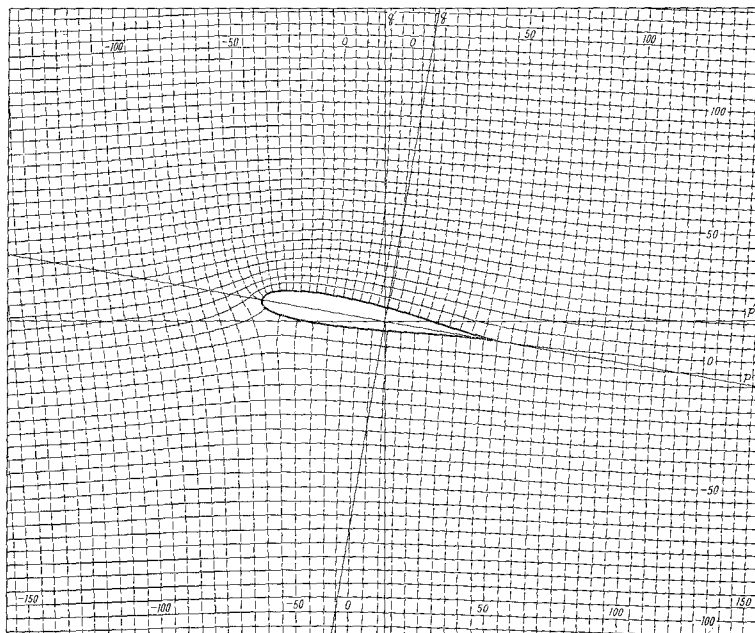
第4図 J翼, \alpha=10^\circ 流線と等ポテンシャル線
