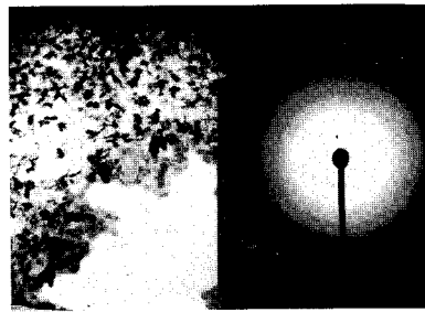
写真—6 硼酸+硼砂 (80 w/o H 2 O) 3 mA/cm 2 , 70 min, 100 kV, I p = 85 mA, ×4200.
