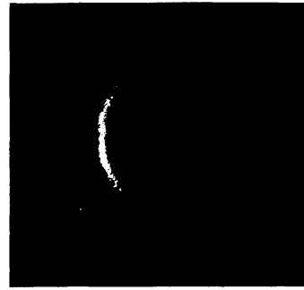
図 9: 鈍頭物体前部の空気の発光現象 (駆動気体: ヘリウム, L/D=61.7 )
