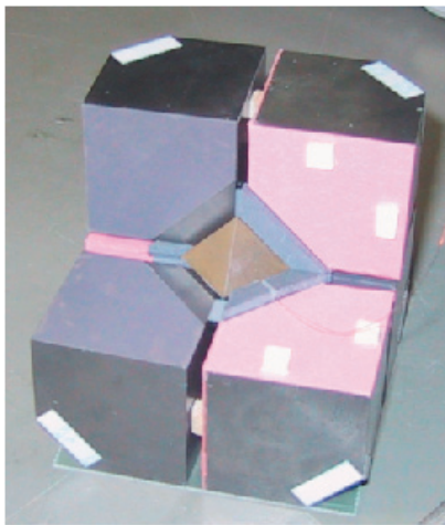
図5 川井式2段アンビル型装置の2段目アンビルアセンブリ
