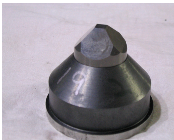
図4 超硬合金 (タングステンカーバイド) 製アンビル
