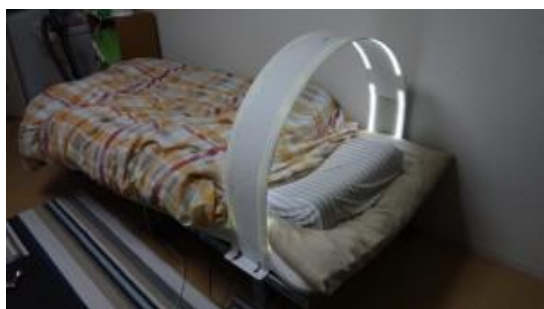
図 1 擬似夜明け療法器 本学で開発した擬似夜明け療法照射器の使用例。最大照度照射時、頭の向きに関わらず、擬似夜明け療法に必要な 250 ルクスが照射される。
