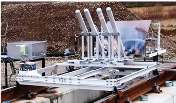
図 1 1 RS-702 走行台車。全長 2 m、空虚重量 72 kg、耐加速度 10 G、制動板耐荷重 32 kN。
