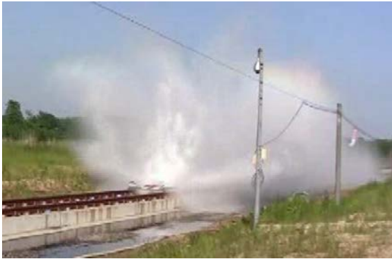
図6 時速 350 km で水路に突入する走行スレッド
