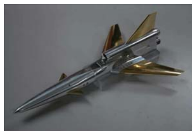
(b) 超音速飛行形態 (KH, 主翼前縁後退角 50 deg.)
