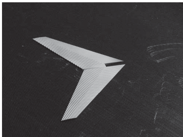
図 5 : 縞状の光を投射して形状測定している様子
