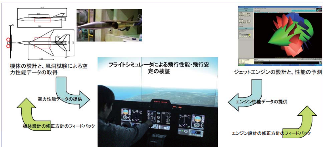
図2：フライトシミュレータ装置を用いた小型超音速飛行実験機の開発手順
