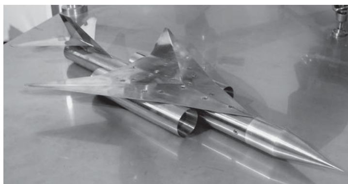
図 2 M 型機体 (固定後退角翼式機体) の機体模型 (スケール 1/5.7)。
