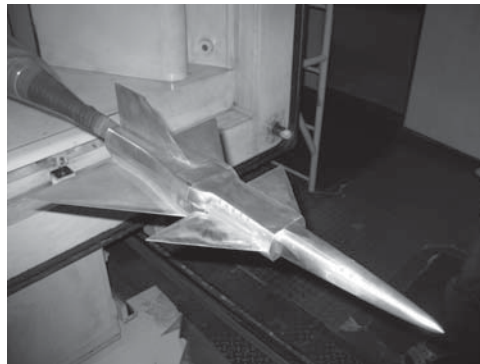
図3 O型機体(固定後退角翼式機体)の機体模型（スケール1/7.27）。
