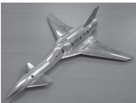
(a) 亜音速飛行形態(KL,主翼前縁後退角30 deg.)
