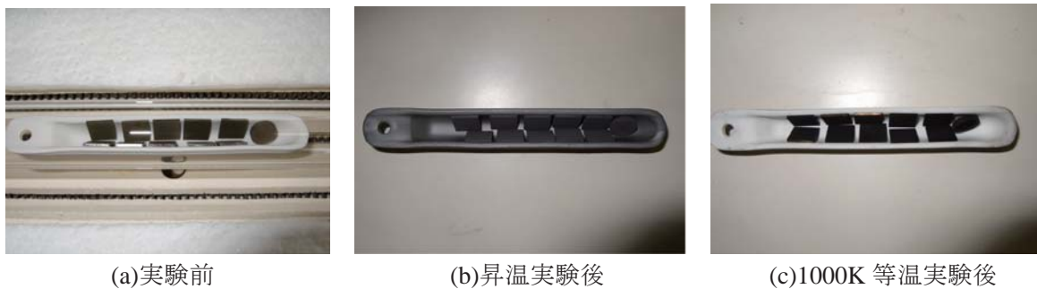
図 3 実験前後の Inco600 試験片の様子 (プロパン濃度 1%)
