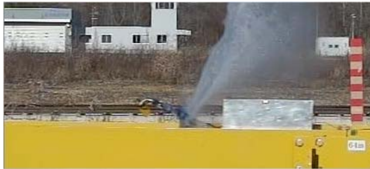
図 6：ハイスピードカメラによる水噴射撮像（平板バケット，側壁なし）
