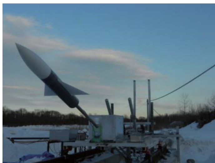
図7:天秤に取り付けられた AGARD-B 模型
