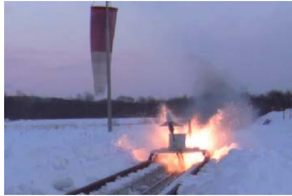
図8:AGARD-B 模型を搭載して走行するスレッド
