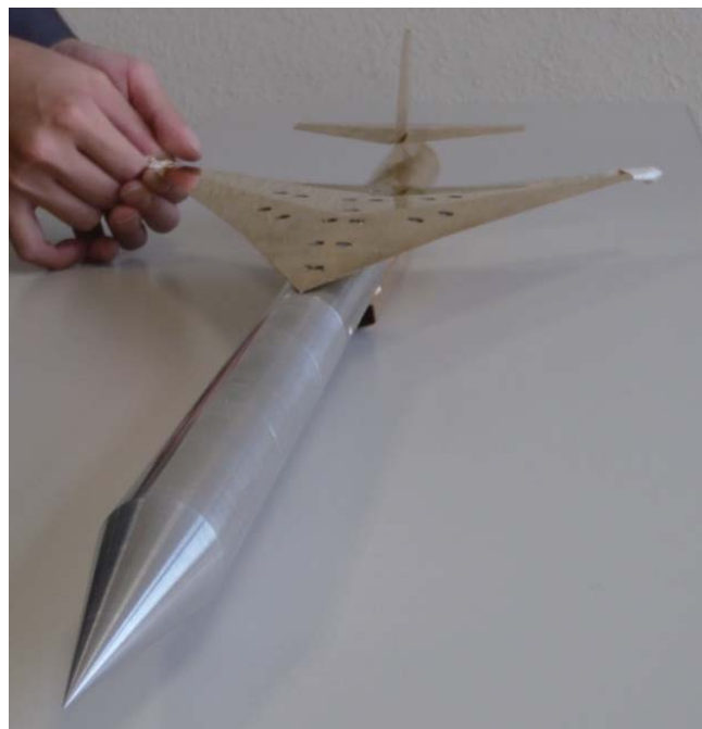
(b) ベースライン形状の風試模型の外観(ノーズ A、インターク B)
