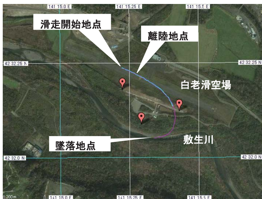
図5-3. 滑走開始から墜落までの飛行軌跡
